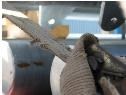
Scheur in spanband. Spanband niet te gebruiken.
