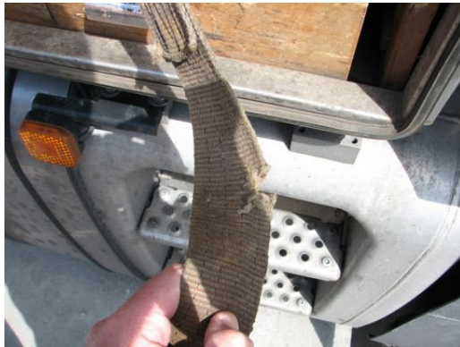
Scheur in spanband. Spanband niet gebruiken.
